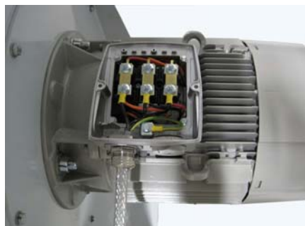
Рисунок 3.15 Подключение двигателя вентилятора
