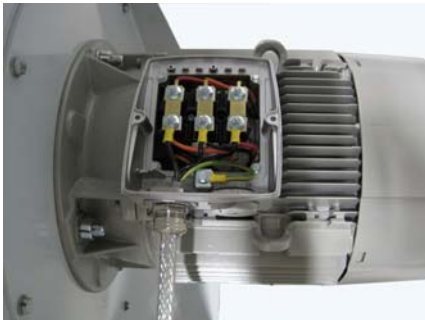
Figure 3.15 Câblage du moteur du ventilateur
