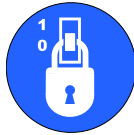
Kuva 7.2 Suojaaminen virran kytkemistä vastaan
