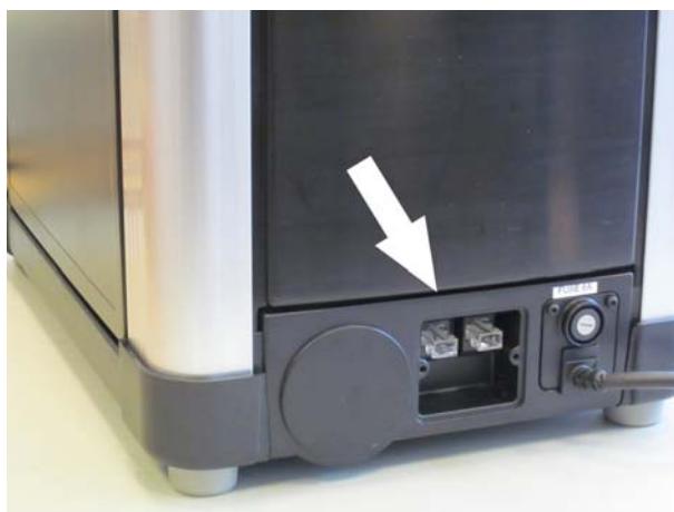
Rysunek 4.4 , 2 porty CAN BUS z założonymi zaślepkami
