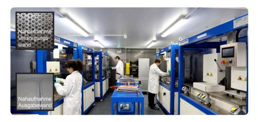
Der 9 x 5 Meter große Trockenraum ist nur ein Teil der Pilotreihe. Er bietet bis zu sechs Mitarbeitern Platz und verfügt über einen durchgängigen Taupunkt von -45°C, was einer relativen Luftfeuchtigkeit von weniger als einem Prozent entspricht.
