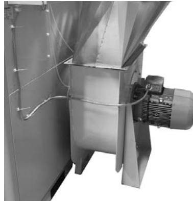
Kuva 3.16 Kuivattavan ilman puhallin
