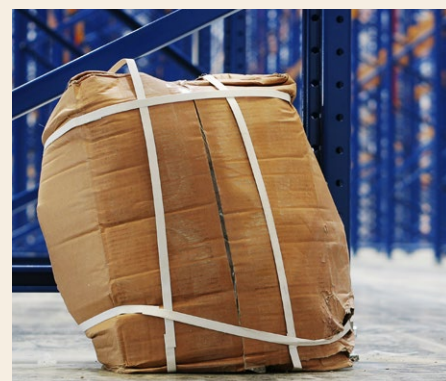
Vattenskador på lagrat gods.
