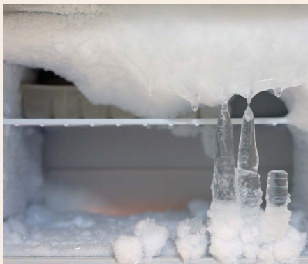
Jään muodostuminen kalusteisiin ja laitteisiin.
