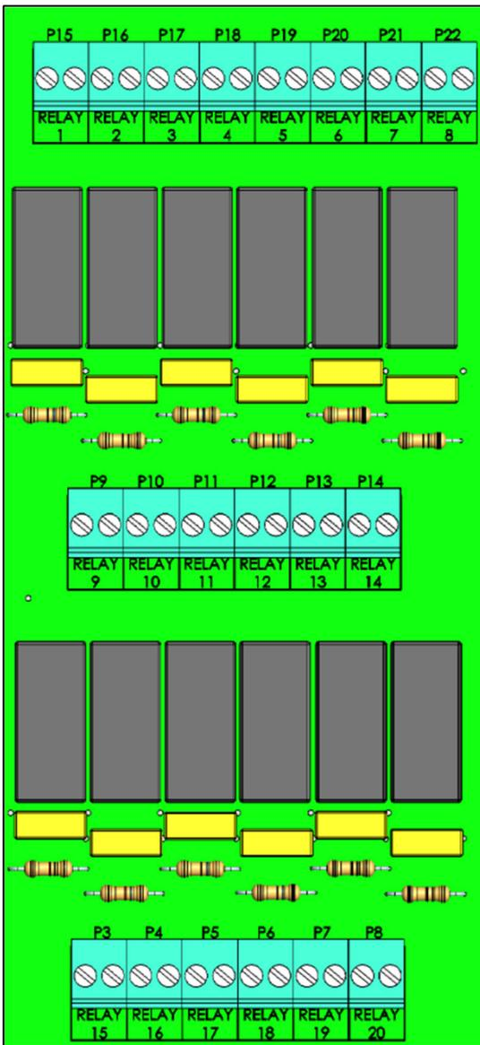
Figura 6: Numerazione di relè (relay) e porte
