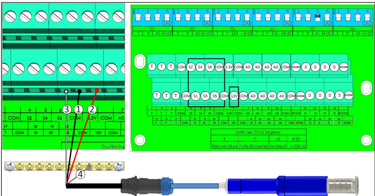
Figura 20: Cablaggio RHS+
