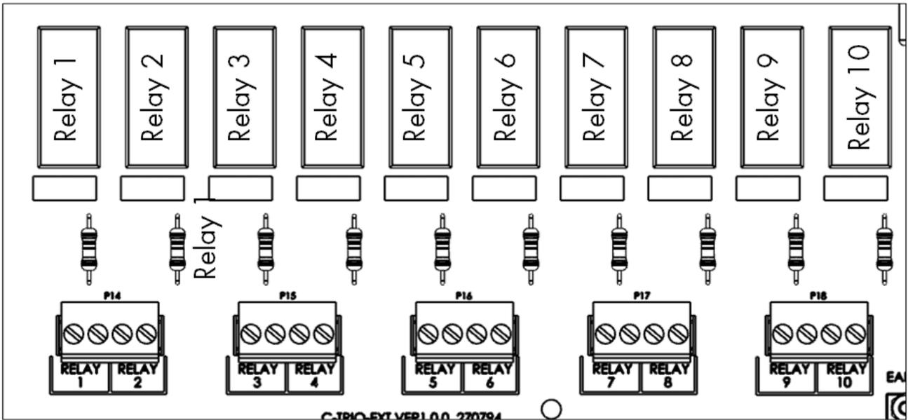
Figura 38: Numerazione di relè (relay) e porte
