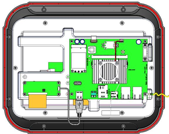
Figura 42: Pannello CPU Trio, vista posteriore
