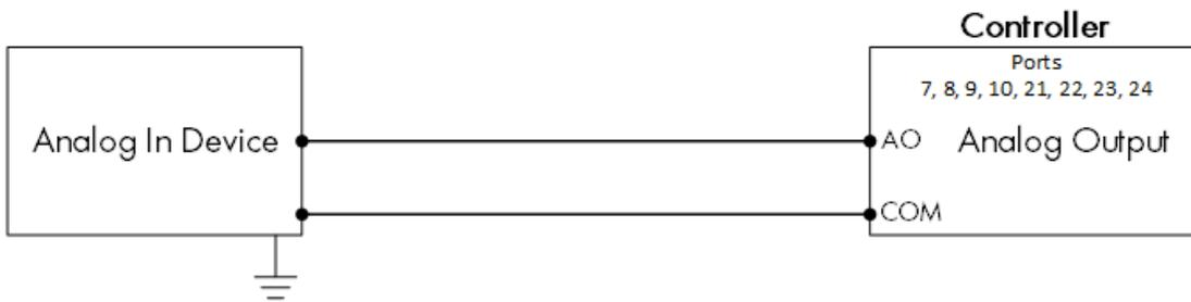
Figura 11: Schema di cablaggio del dispositivo analogico (analog)
