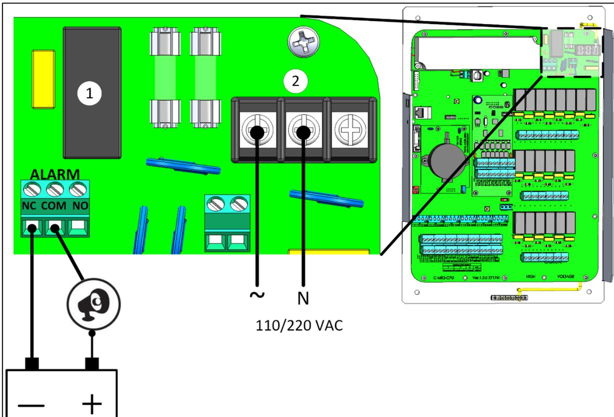
Figura 49: Relè di allarme e porte di alimentazione
