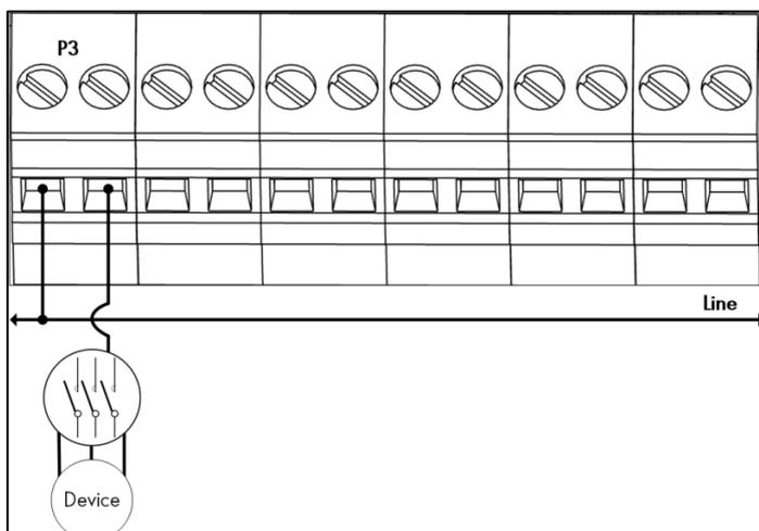
Figura 5: Vista dettagliata del cablaggio del relè
