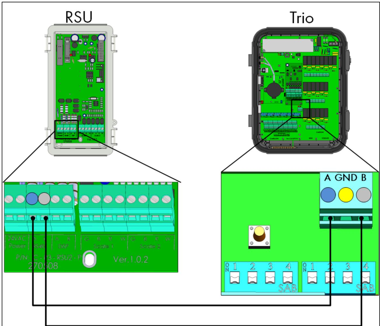
Figura 32: Trio – Cablaggio RSU
