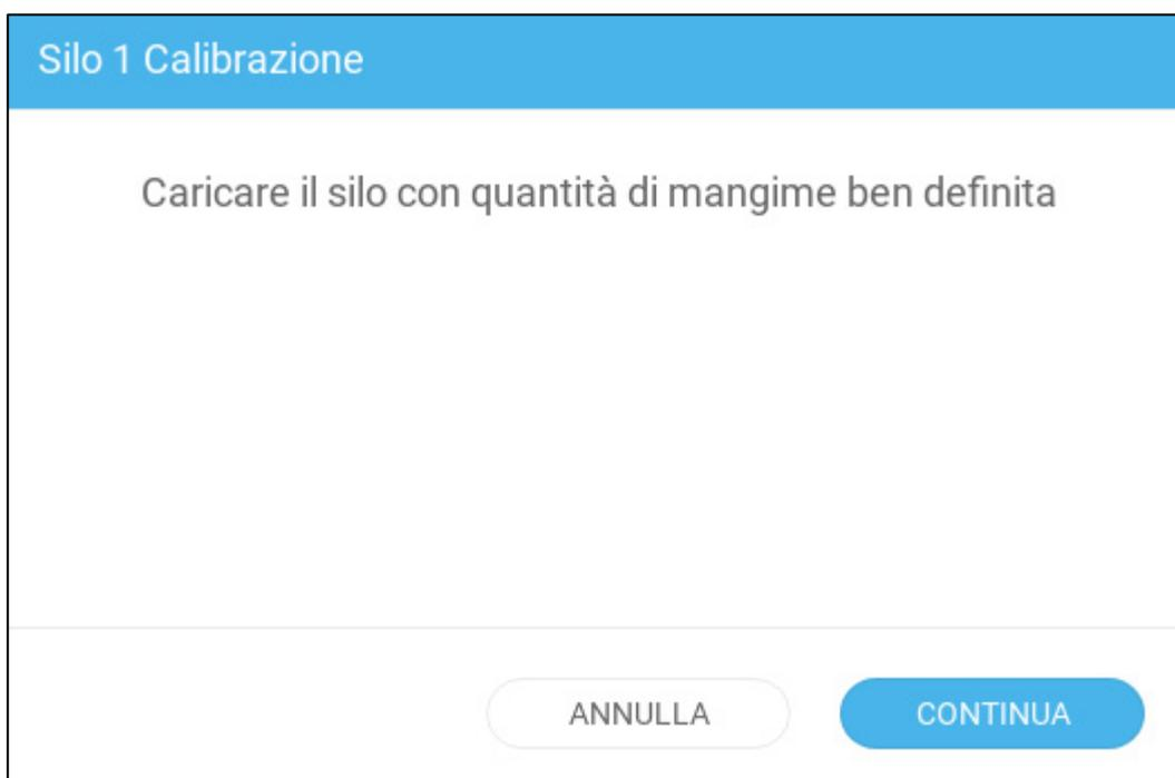
4. Riempire il silo con una quantità nota di foraggio. In questo esempio, il silo contiene 100 kg di foraggio.
