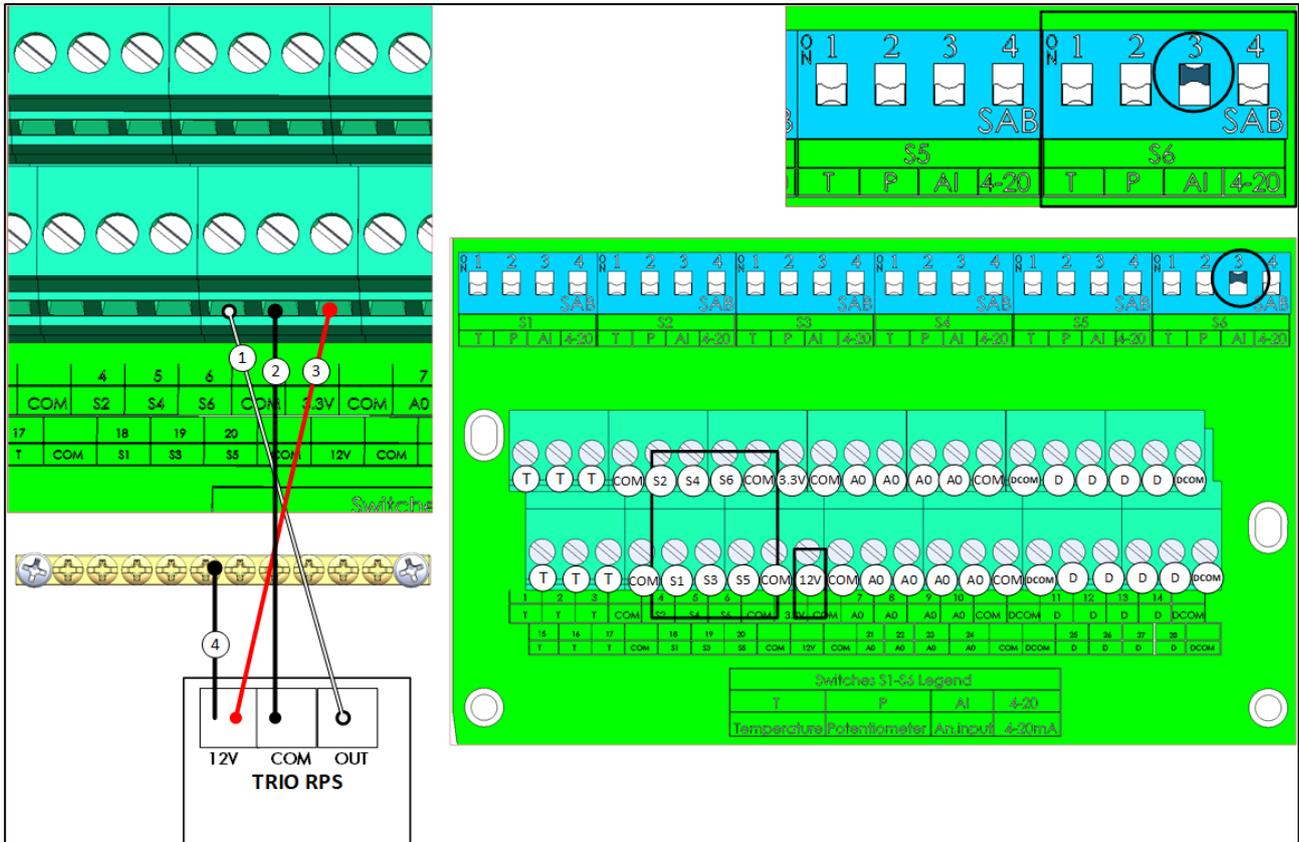
Figura 27: Cablaggio RPS
