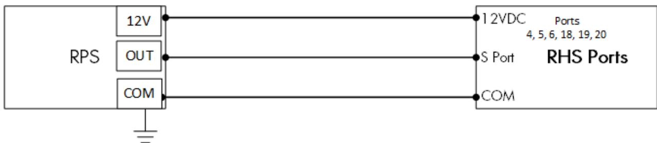
Figura 28: Schema del cablaggio RPS
