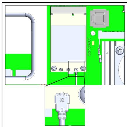
5. Infilare il cavo del modem nel connettore come mostrato di seguito.
