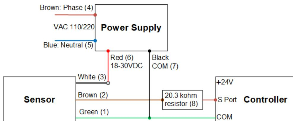
Figura 25: Schema di Cablaggio del Sensore (Sensor) Ammoniaca
