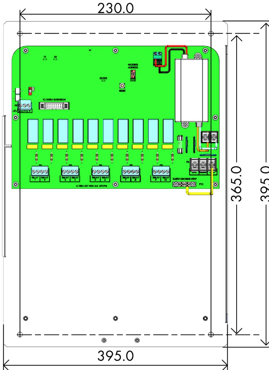
Figura 52: Dimensioni pannello posteriore di espansione
