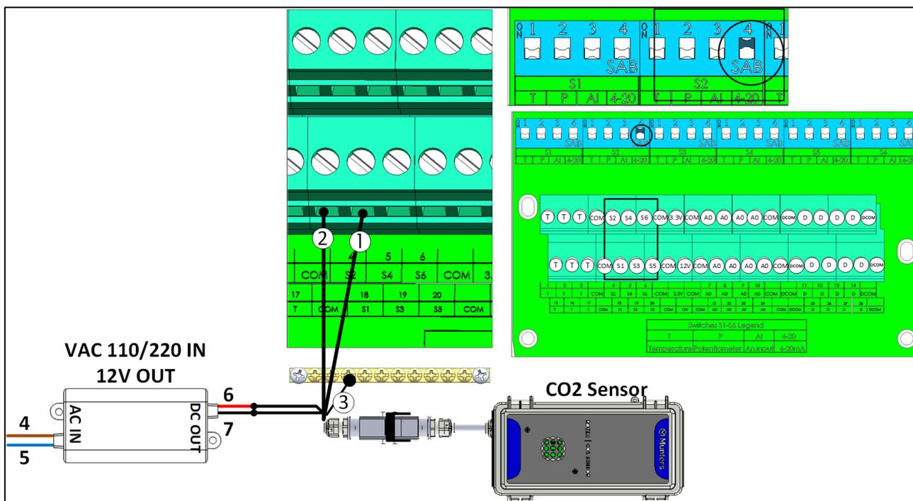
Figura 14: Cablaggio del sensore di CO2 (CO2 sensor)
