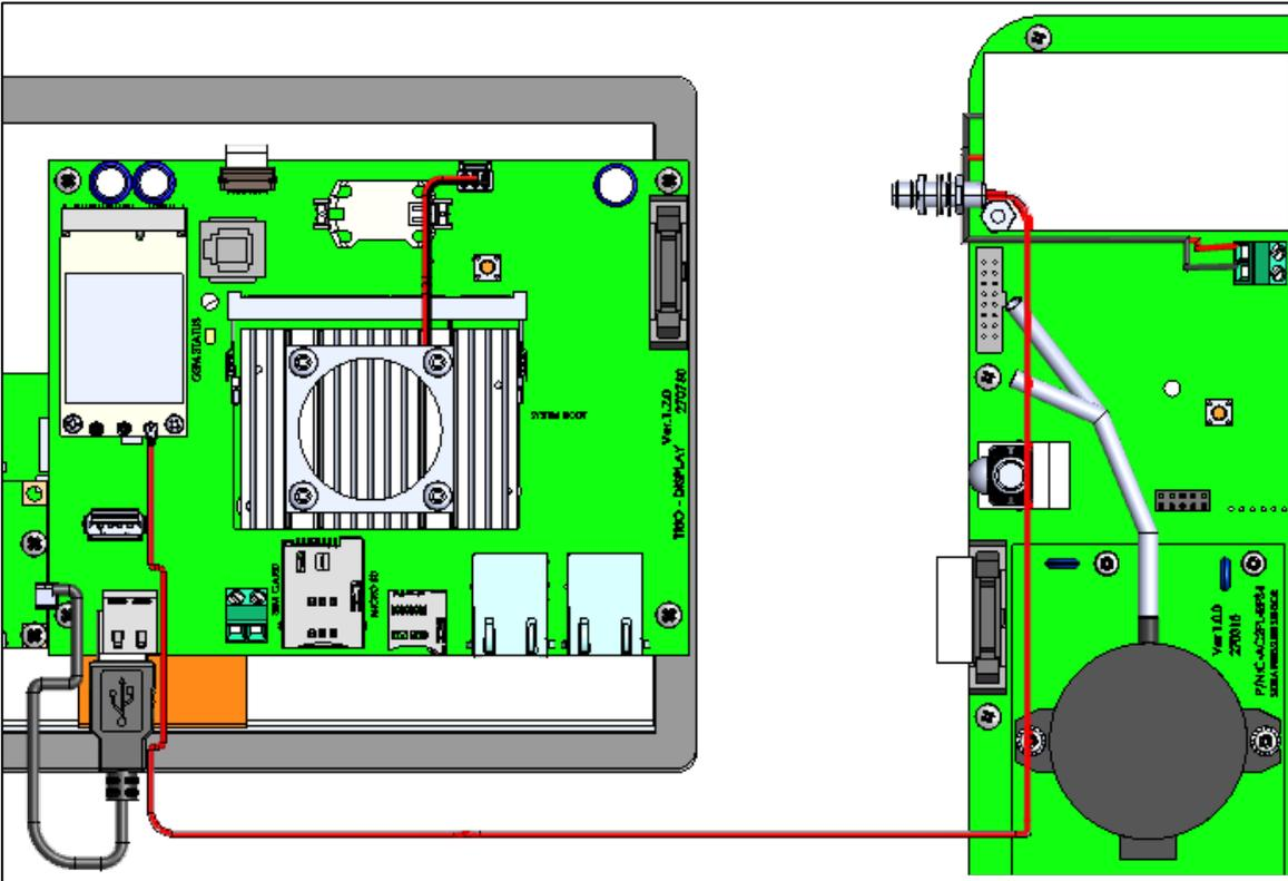
6. Rimuovere il cappuccio di chiusura e collegare l'antenna. (Per le unità precedenti, fare riferimento alla sezione successiva.)
