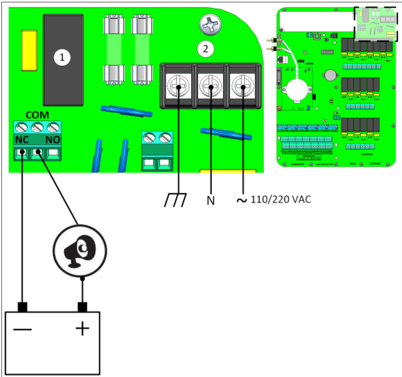
Figura 7: Relè di allarme e Porte di alimentazione
