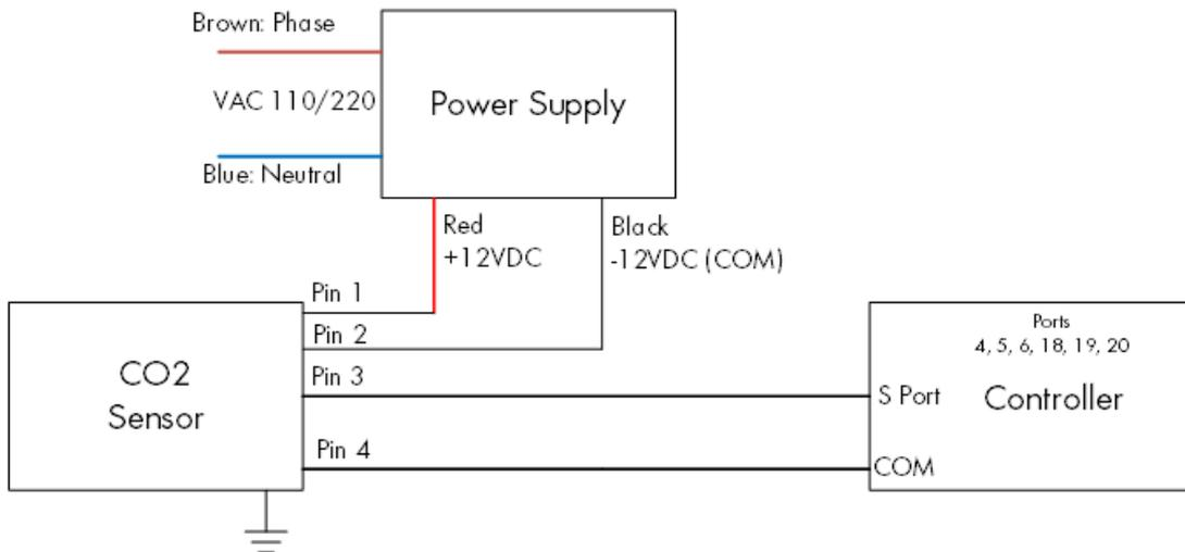
Figura 15: Schema di cablaggio del sensore di CO2
