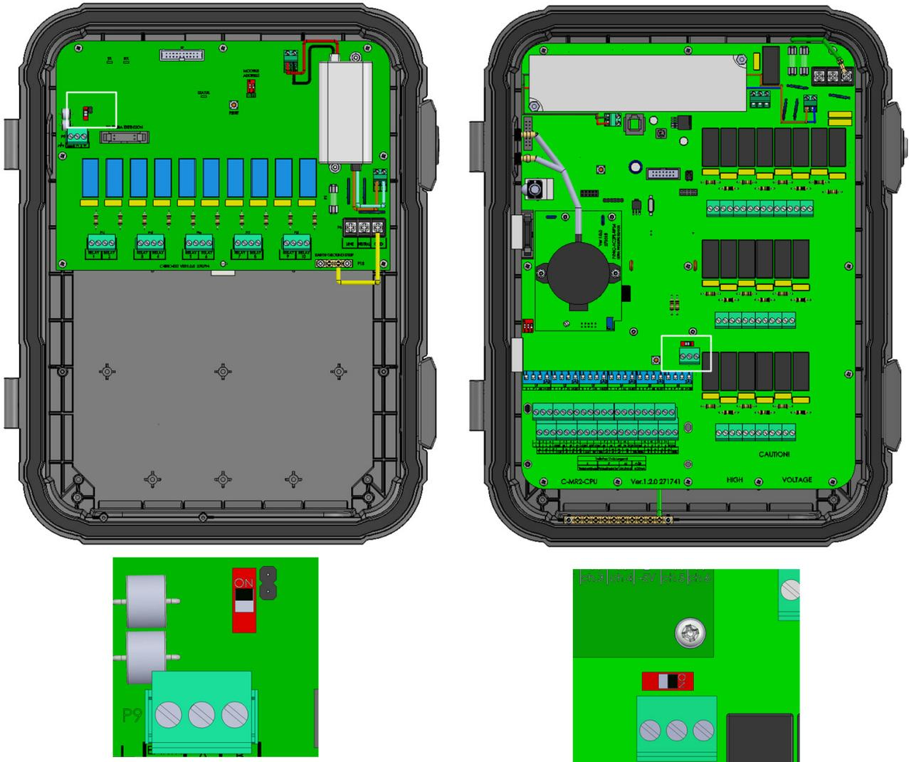
*NOTE* Quando il TRIO non è collegato a un TRIO Expansion, la posizione del dipswitch di terminazione è irrilevante
