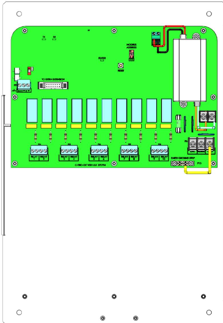
Figura 51: Pannello relè di Trio Expansion, vista frontale
