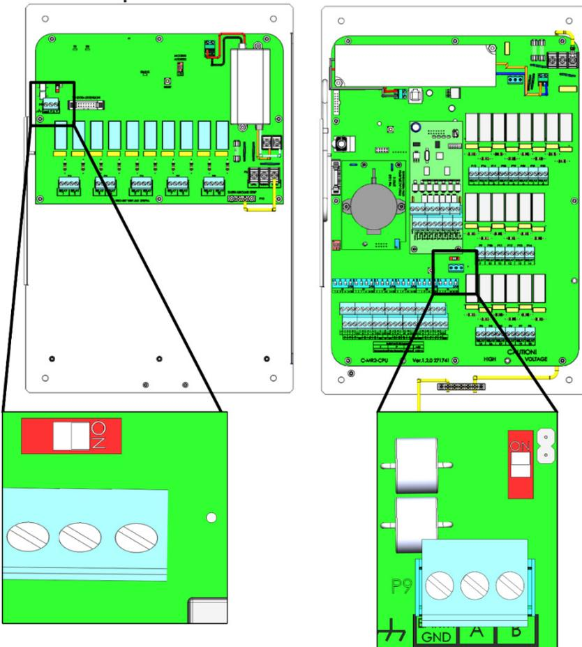
**NOTE** Quando il pannello Trio non è collegato a un dispositivo di espansione, la posizione del dip-switch di terminazione non è rilevante.
