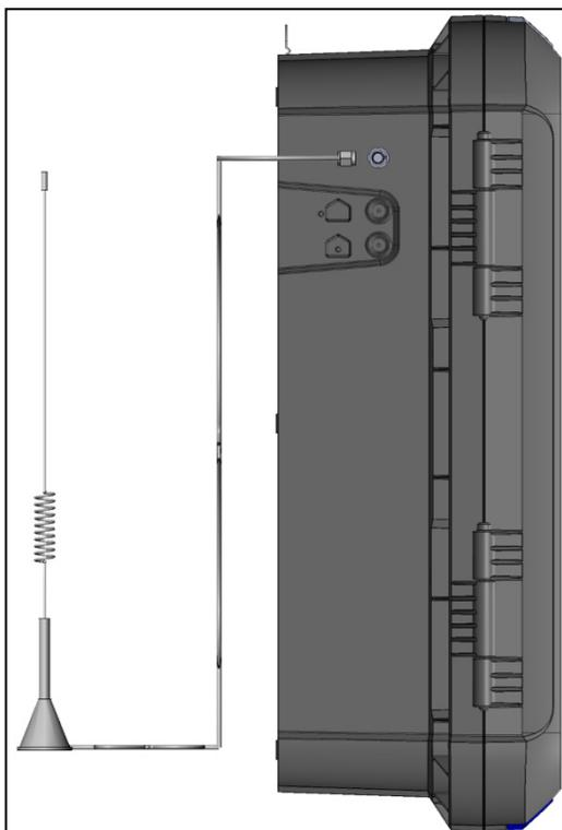
7. Fissare l'antenna utilizzando il supporto fornito.
