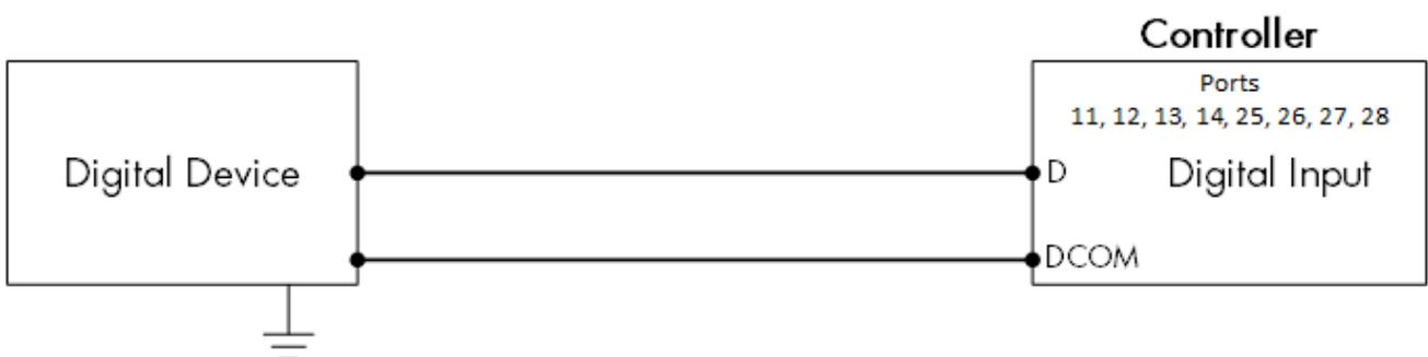
Figura 13: Schema di cablaggio del dispositivo digitale (digital)
