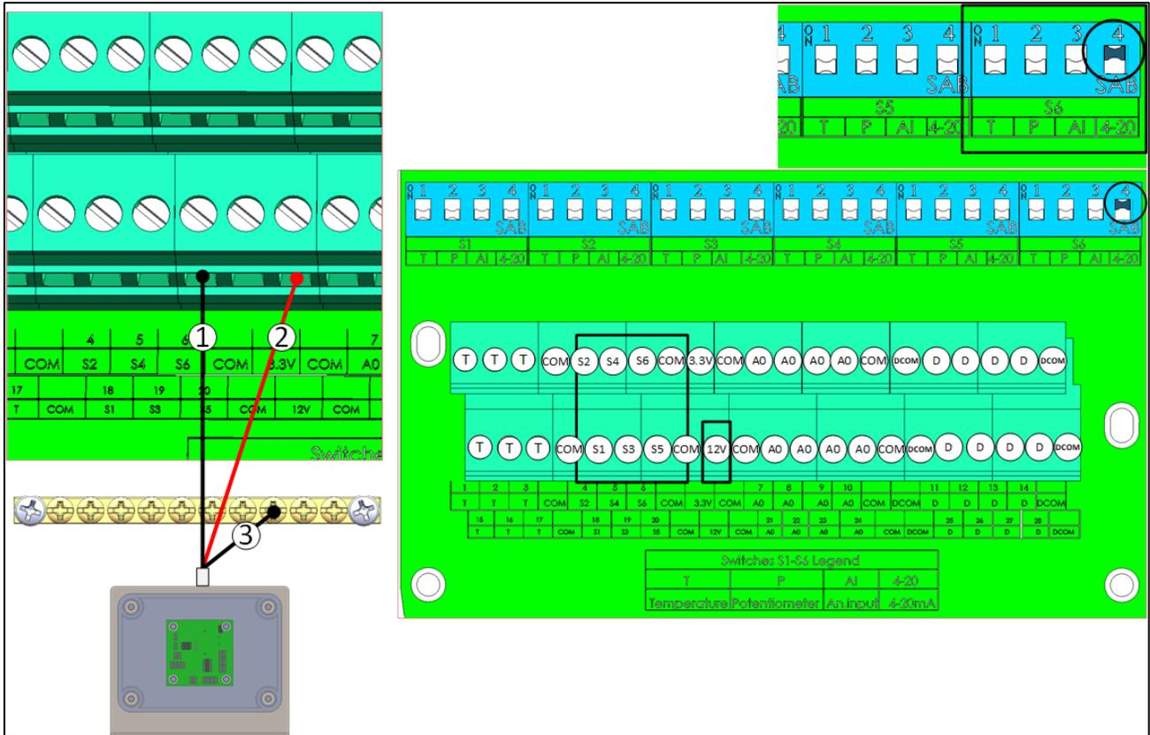
Figura 26: Cablaggio del sensore di luce
