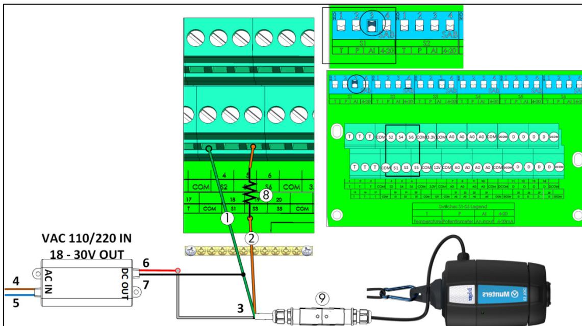
Figura 24: Cablaggio del Sensore di Ammoniaca
