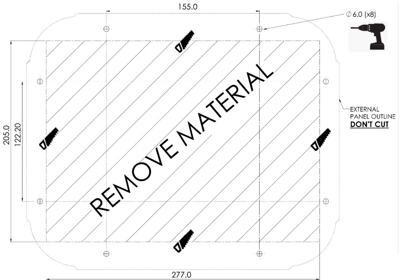
Figura 47: Dimensioni di taglio e foratura dei pannelli (millimetri)
