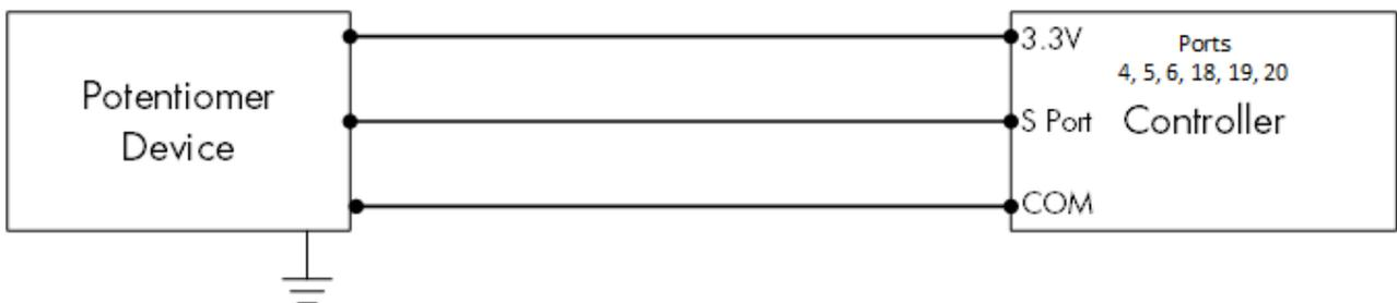
Figura 23: Schema di cablaggio del potenziometro (potentiometer device)
