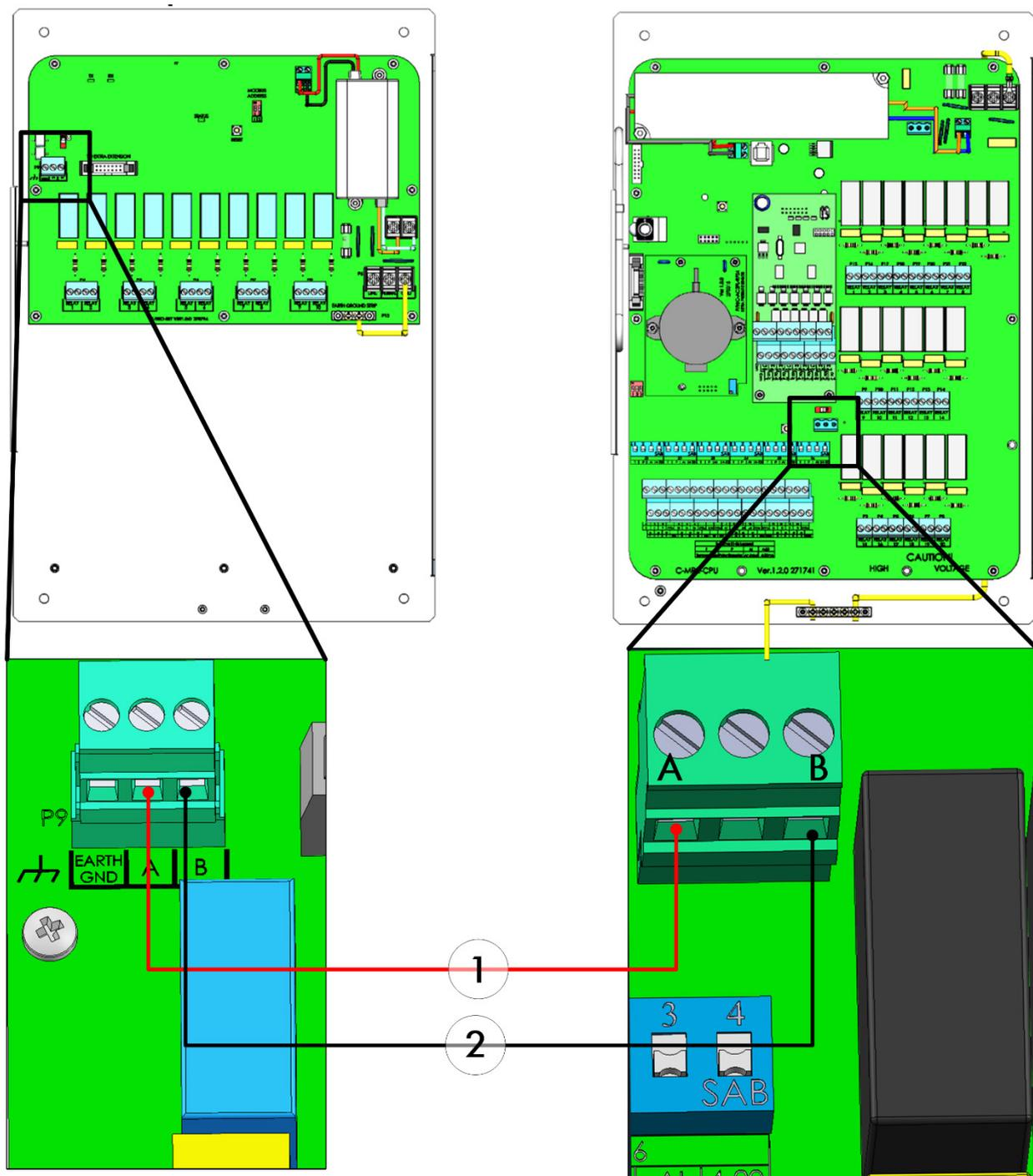
Figura 55: Cablaggio per supporto pannello/supporto pannello di espansione
