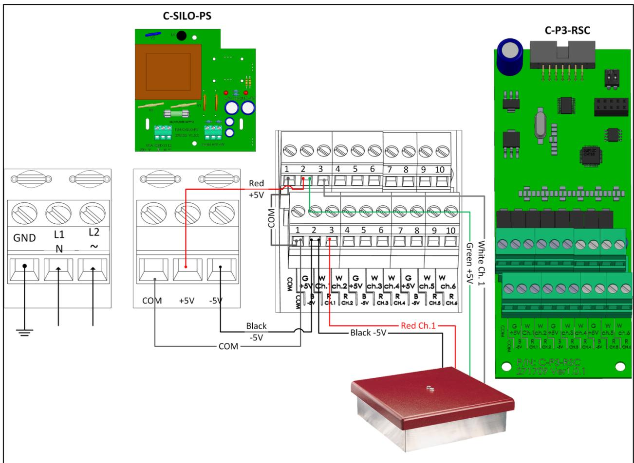
Figura 30: Cablaggio Scheda della Bilancia all' Alimentazione e alla Bilancia per Volatili
