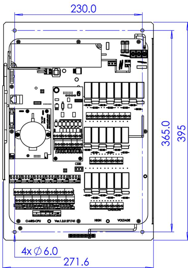
Figura 45: Dimensioni del pannello posteriore
