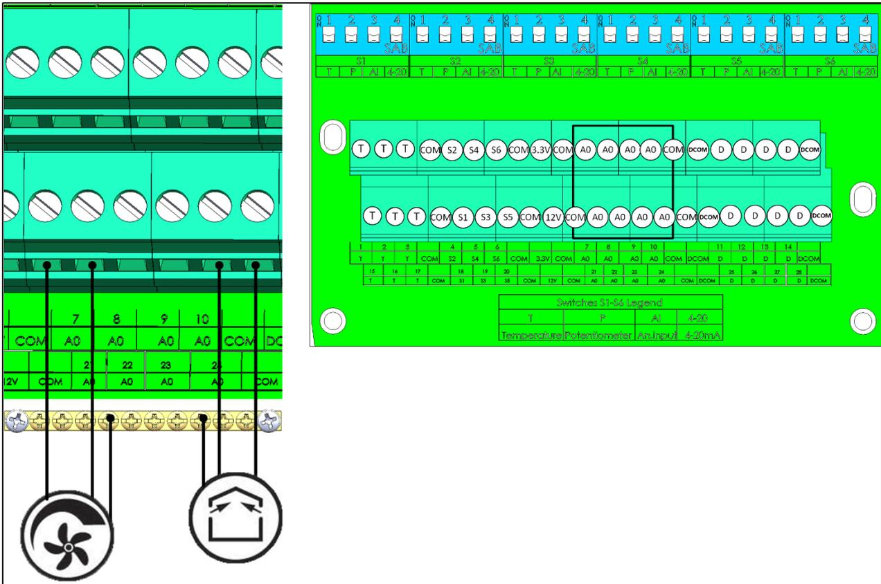
Figura 9: Dispositivi di uscita analogica (esempi)
