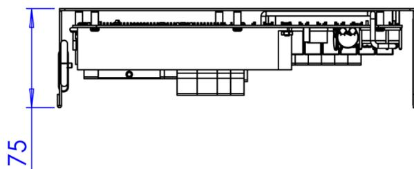
Figura 46: Dimensioni profondità pannello posteriore
