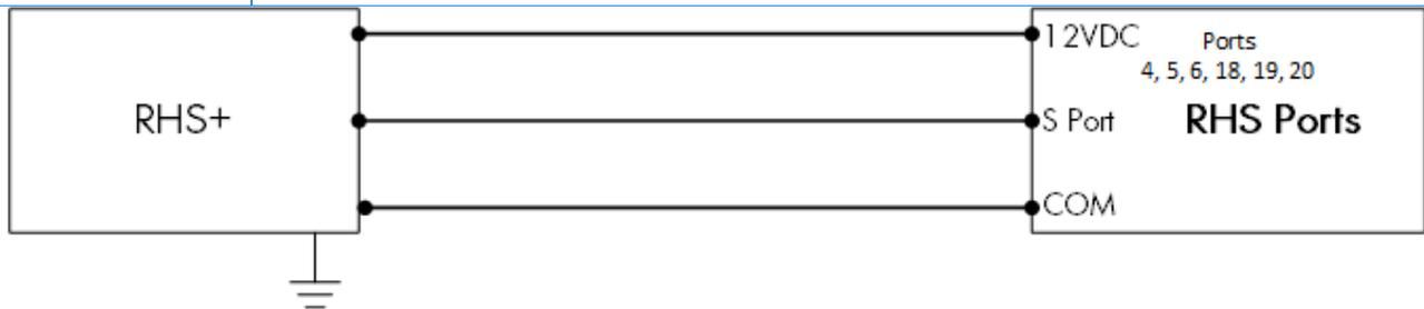
Figura 21: Schema di cablaggio del sensore RHS+
