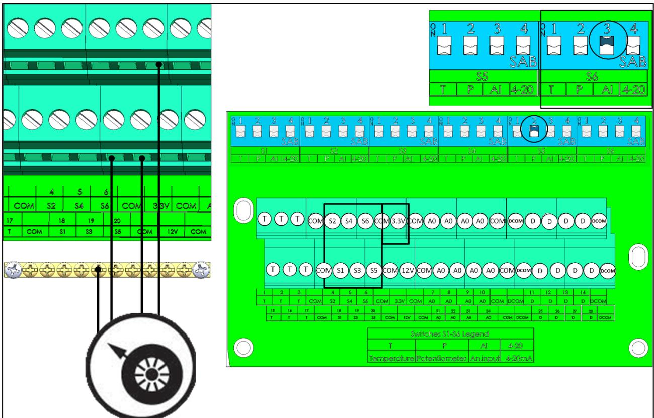
Figura 22: Cablaggio potenziometro
