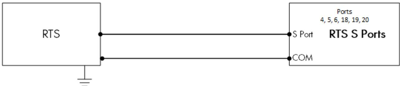
Figura 19: Schema di cablaggio RTS S Porta
