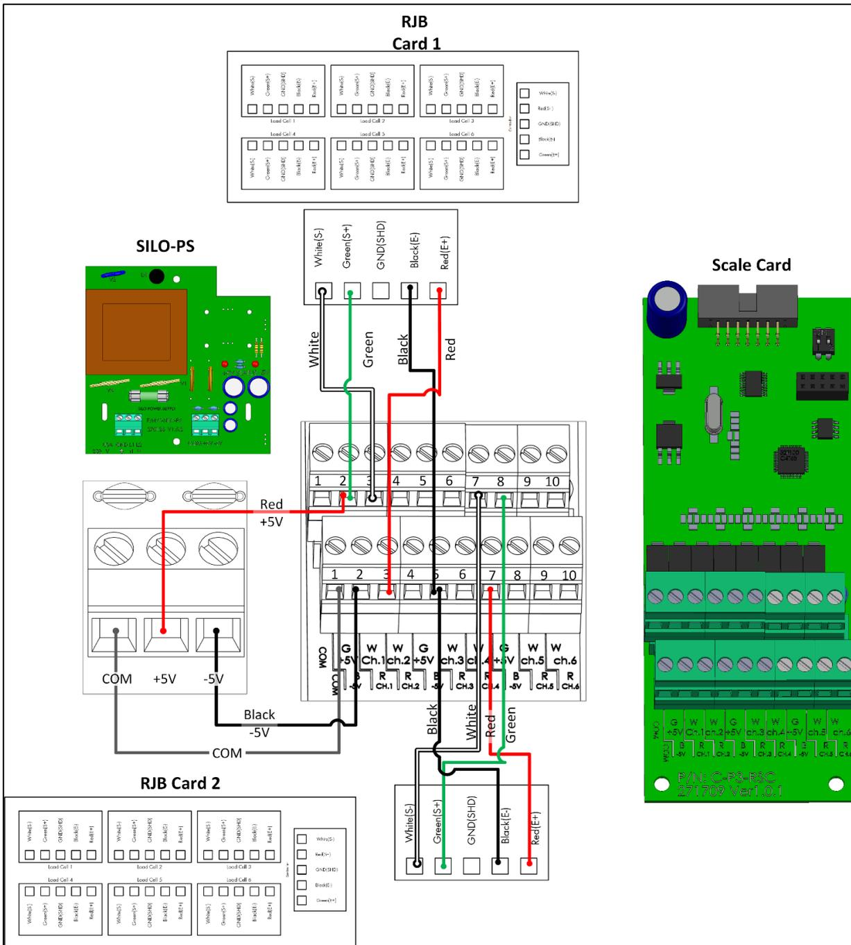
Figura 31: Cablaggio Silo
